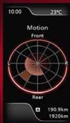
Visualizzazione dell'accelerazione laterale e longitudinale in tempo reale.
