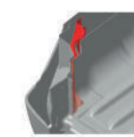
Rinforzo vano di carico
