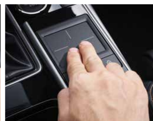
Volume: Muovi 2 dita verso l'alto/il basso Sintonizzatore: Muovi 2 dita verso sinistra/destra
